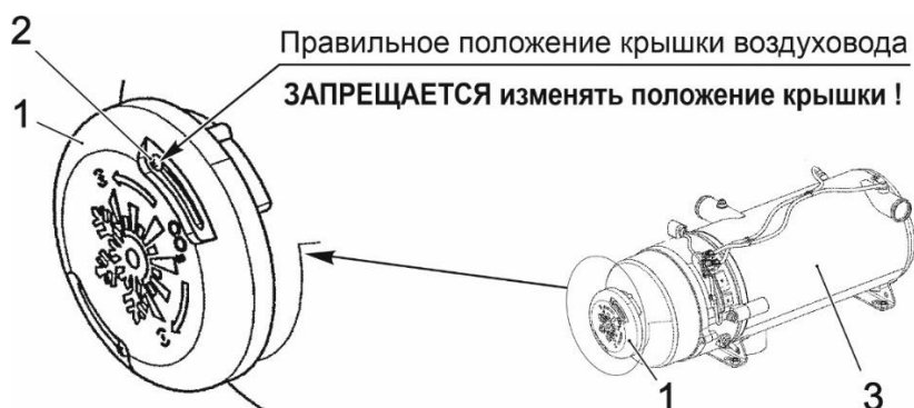
Рис. 14.4 Положение крышки воздуховода подогревателя 30SP-24
