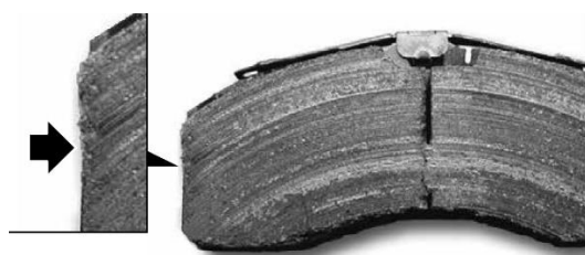
Рис. 12.4 Тормозная колодка с допустимыми повреждениями
