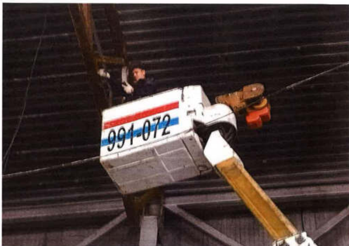
Фотография 2.12 – Толщинометрия конструкций покрытия
